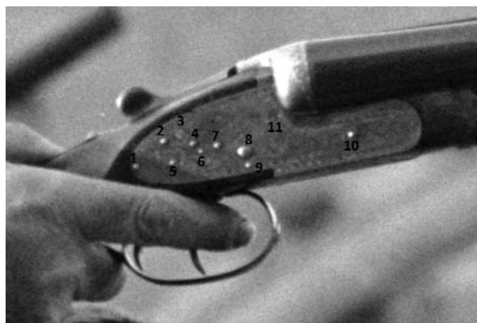
Классический подкладной (bar action) замок на ружье Хемингуэя. 1. Ось крепления пружины интерцептора (перехватывающего шептала). 2. Ось крепления пружины шептала. 3. Выход винта, скрепляющего боковые основания. 4,7,9. Крепление личинки. 5. Ось интерцептора. 6. Ось шептала. 8. Ось курка. 10. Ось фиксатора боевой пружины. 11. Винт крепления бокового основания
