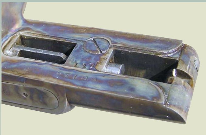
Илл. 4. Нижняя запирающая планка Э. Уитмора с длинным вертикальным ребром в модели образца 1889 года
