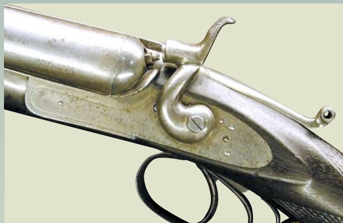
Илл. 5. Один из модифицированных образцов охотничьих ружей с верхним поднимающимся рычагом – Модель 1876. От других двустволок модельного ряда узнаётся по конфигурации курка (сравните с илл. 3)
